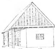
Fig. 8. Holzhaus in Teplitz. Die Thore sind cassirt und die Thür nach der Küche verlegt. Das Fenster ist ausnahmsweise ein Doppelfenster. Der First ist noch über der Frontmitte.
